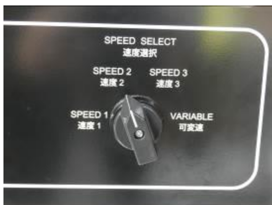
可変速機能付装置（運転室内）
