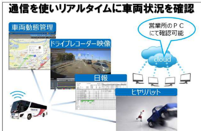
《クラウド型デジタルタコグラフ・ドライブレコーダー 運用イメージ》
