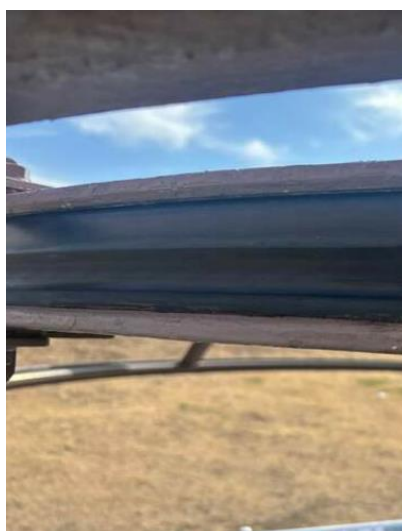
・ゴムライナー溝の消耗による亀裂に伴う整備
