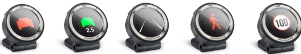
①追突警報 ②車間距離警報 ③車線逸脱警報 ④歩行者衝突警報 ⑤速度認識読取・警報
